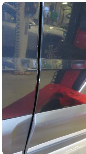
1.2 Rust/korrosjon Rustflekker rundt om på alle dørene.
