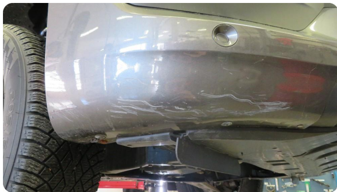
1.5 Ripe(r) Skade på fanger hjørne og noen små riper lenger oppe.
