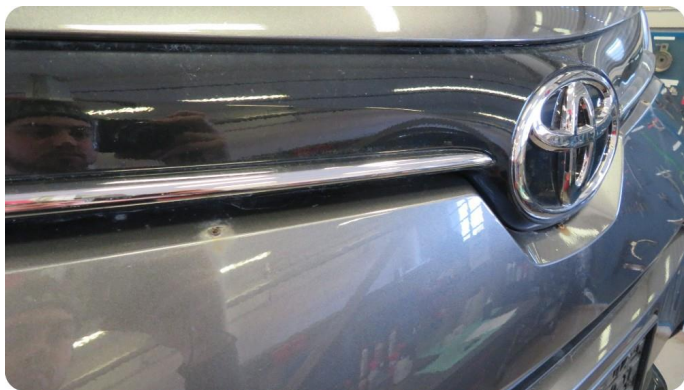
1.4 Øvrige feil Hull i fanger etter støttestag til ekstralys.
