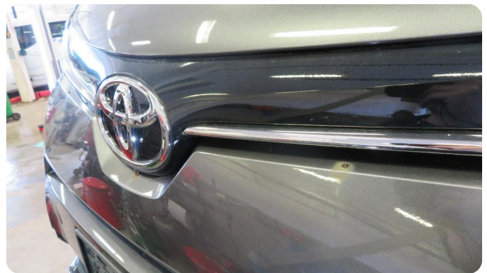
1.4 Øvrige feil Hull i fanger etter støttestag til ekstralys.
