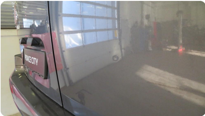
1.1 Bulk med lakkskade Bulk midt på luka.
