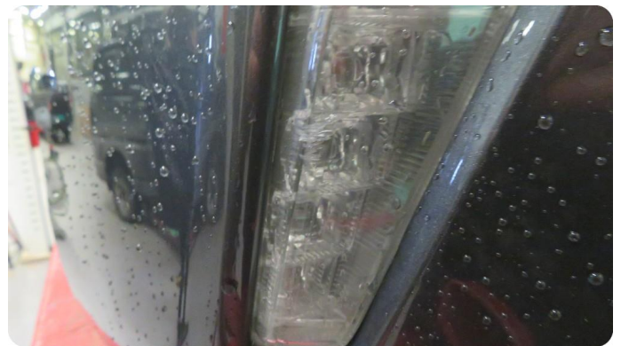
2.2 Sprukket/knust Sprekk i begge lamper i speil å framme
