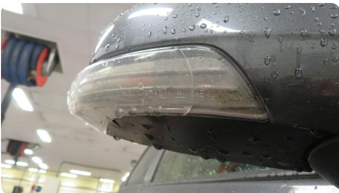
2.2 Sprukket/knust Sprekk i begge lamper i speil å framme
