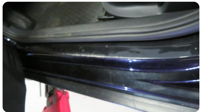
1.4 Slitt gjennom lakk Slitt ned til metall.
