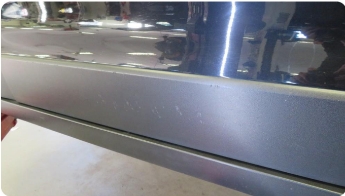
1.1 Løse/skadede lister Hakk/riper i nedre list på dør
