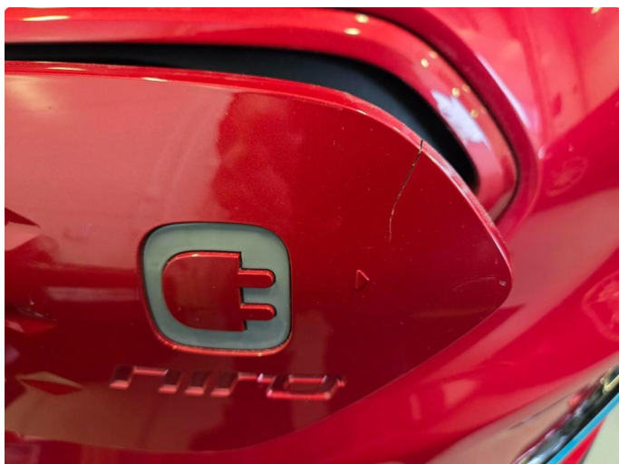
1.1 Sprekk i ladeluke
