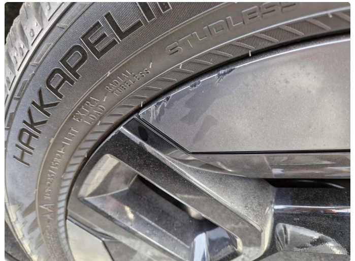
1.3 1 Hjulcapsel noe kantkjørt
