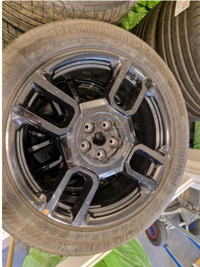
1.2 Sommerhjul: Merker på felg etter kapsler.
