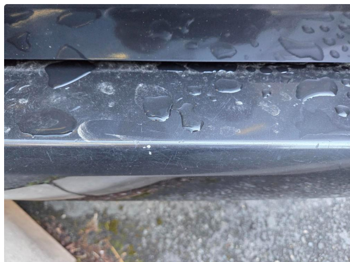
1.1 Bruksslitasje - Diverse riper og lakksår
