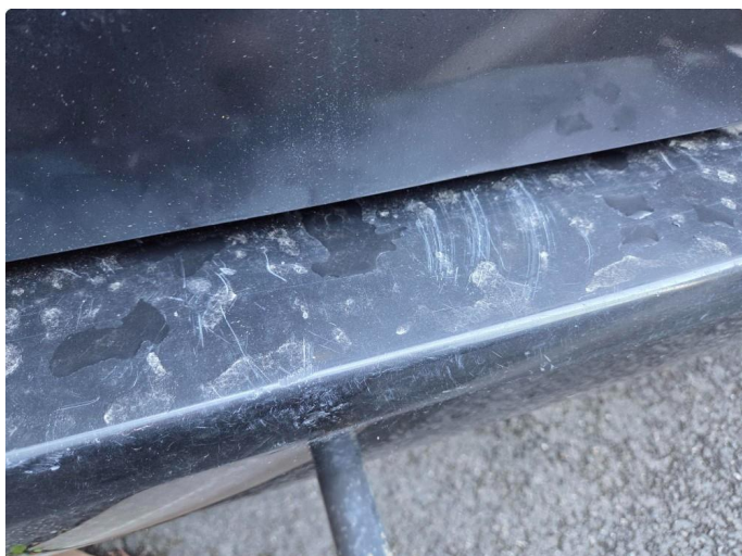
1.1 Bruksslitasje - Diverse riper og lakksår
