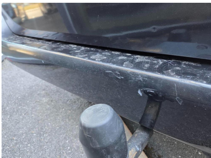
1.1 Bruksslitasje - Diverse riper og lakksår
