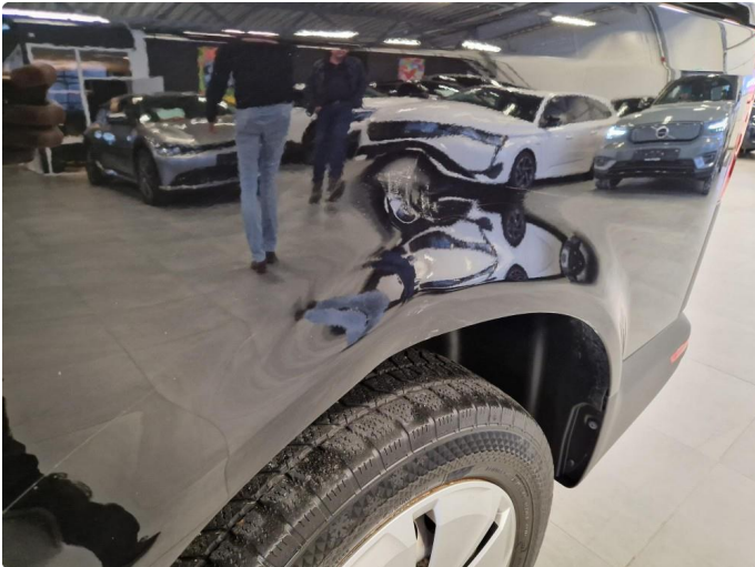
1.1 Bulk i skjerm venstre side bak - Blir utbedret
