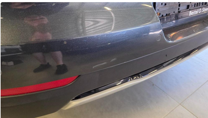
1.5 Riper og sår i lakk - Støtfanger bak - venstre side
