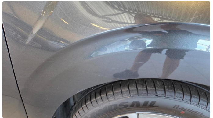
1.4 Riper og sår i lakk - Skjerm høyre foran
