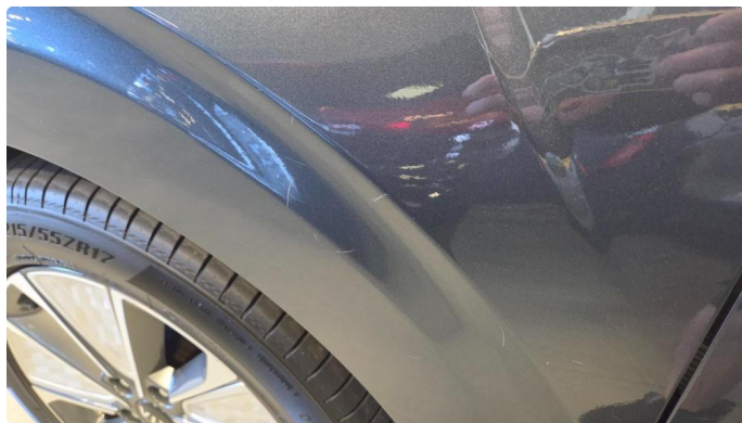
1.8 Riper og sår i lakk - Skjerm venstre foran
