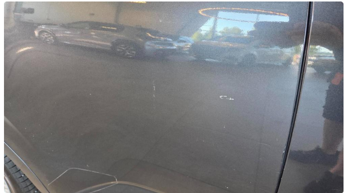
1.2 Riper og sår i lakk - Dør høyre bak
