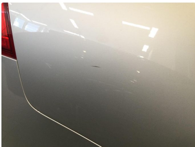
1.2 Ripe(r) ned til grunning
