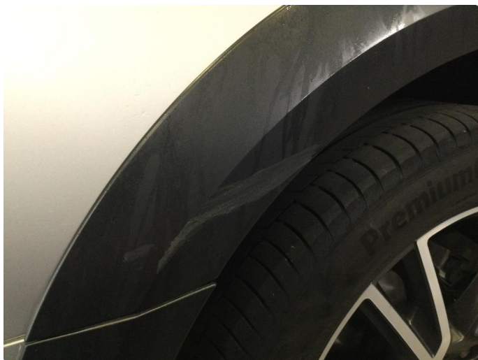
1.2 Ripe(r) ned til grunning
