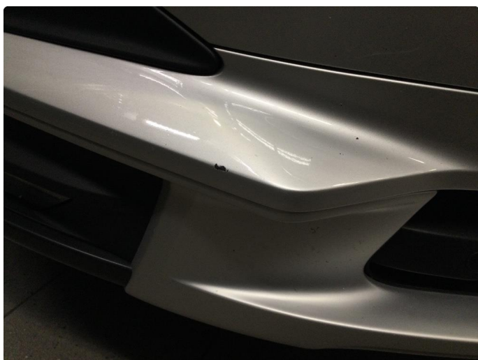
1.5 Ripe(r) ned til grunning
