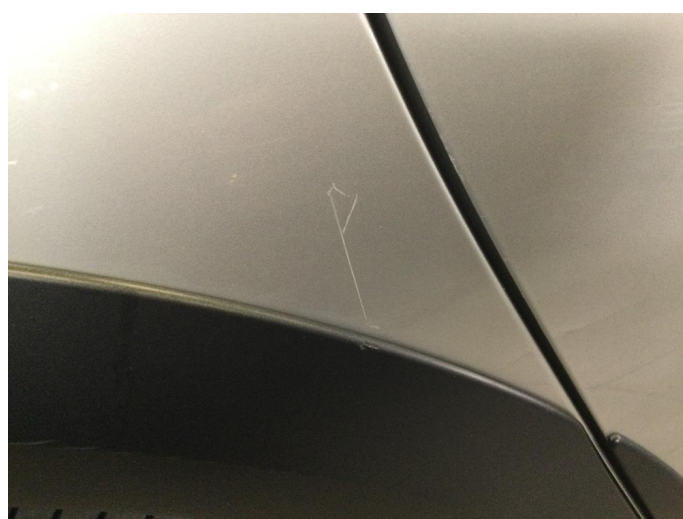
1.2 Ripe(r) ned til grunning
