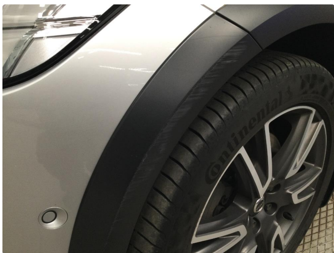
1.5 Ripe(r) ned til grunning
