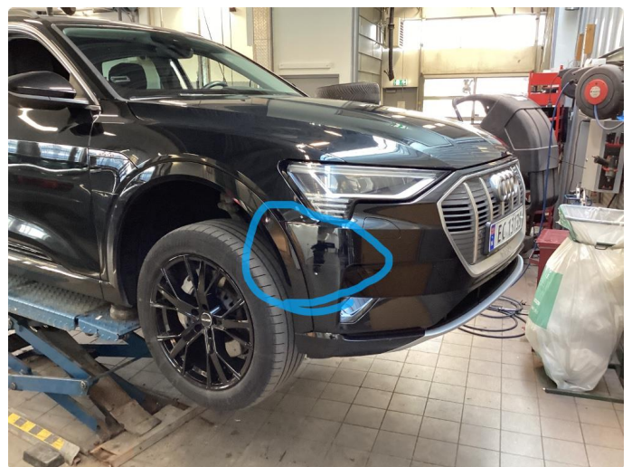
1.3 Ripe(r) ned til grunning
