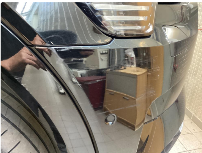
1.3 Ripe(r) ned til grunning
