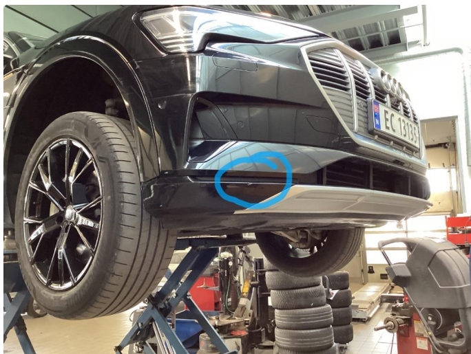
1.4 Ripe(r) ned til grunning
