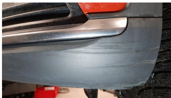
1.2 Ripe(r) ned til grunning
