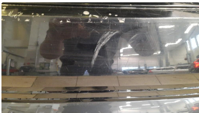
1.1 Ripe(r) ned til grunning
