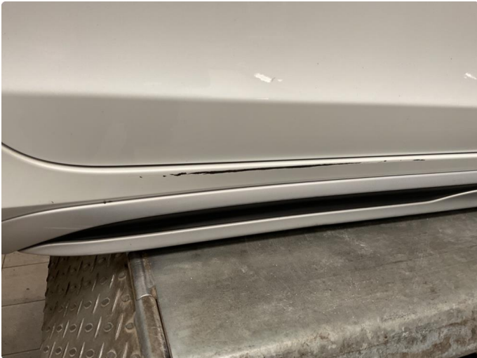
1.1 Ripe(r) ned til grunning
