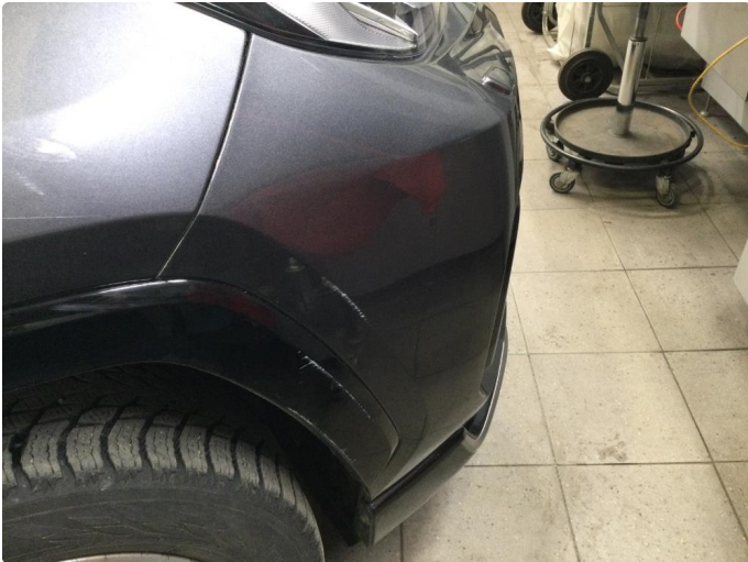
1.1 Ripe(r) ned til grunning
