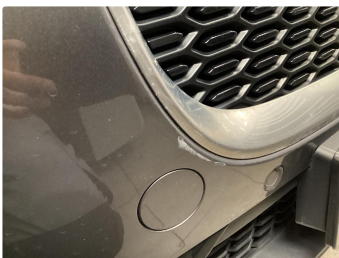
1.1 Ripe(r) ned til grunning
