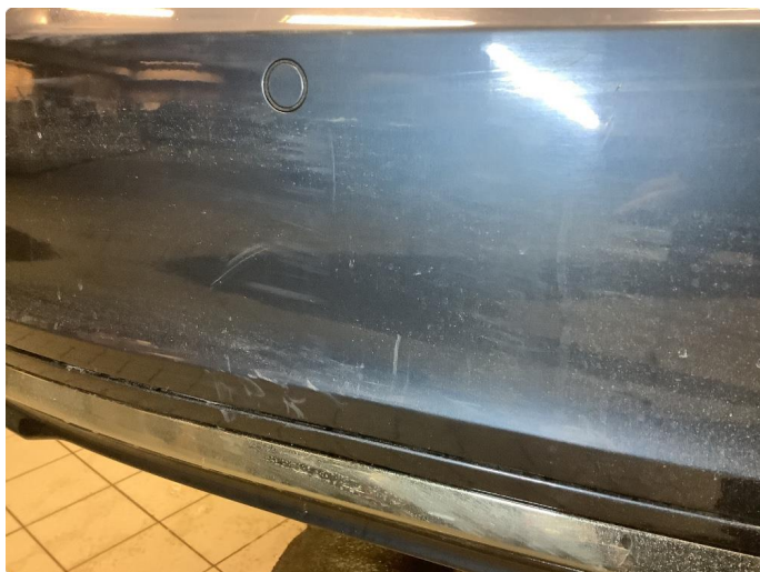
1.5 Ripe(r) ned til grunning
