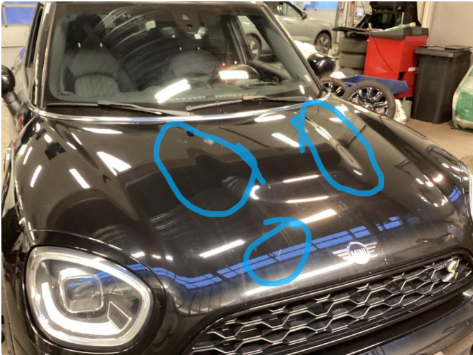
1.1 Ripe(r) ned til grunning
