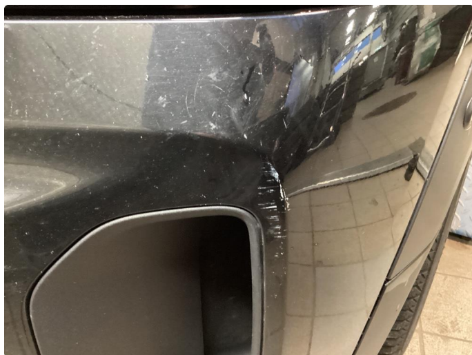
1.3 Ripe(r) ned til grunning
