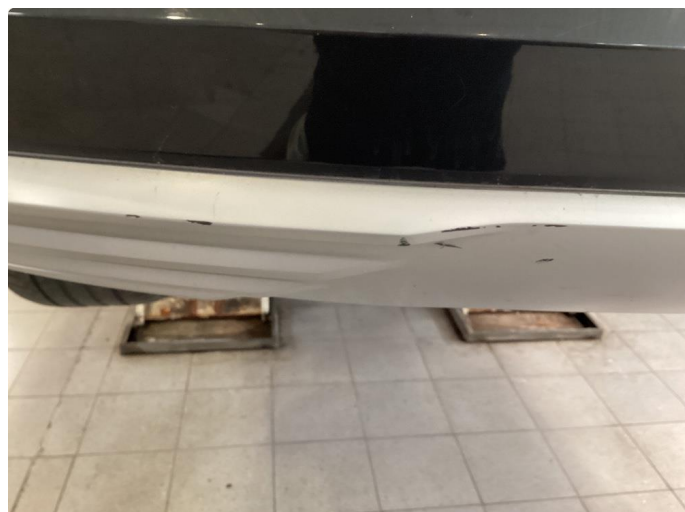
1.1 Ripe(r) ned til grunning
