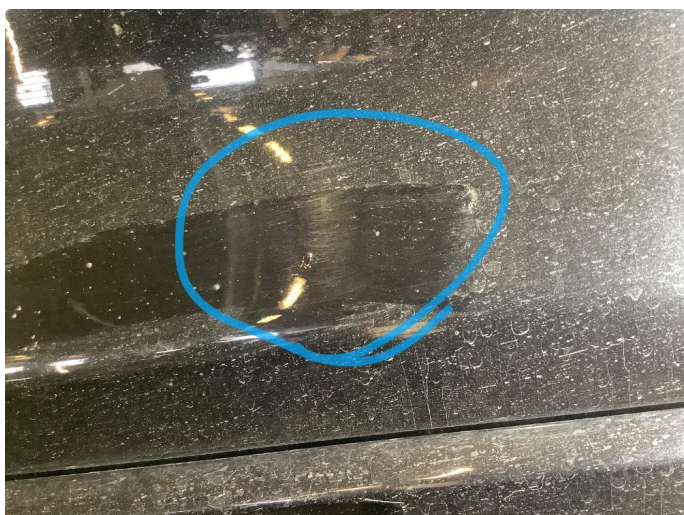
1.1 Steinsprut med rust
