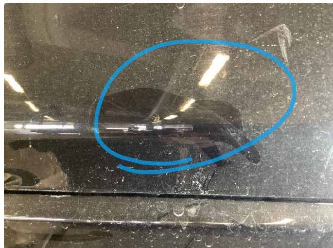
1.1 Steinsprut med rust
