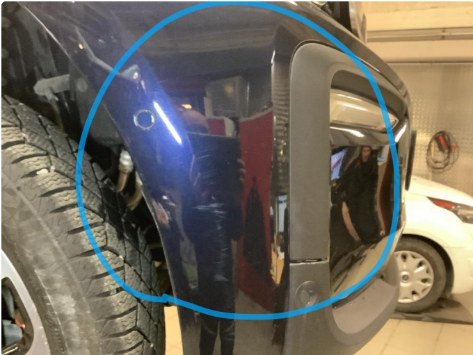
1.1 Ripe(r) ned til grunning
