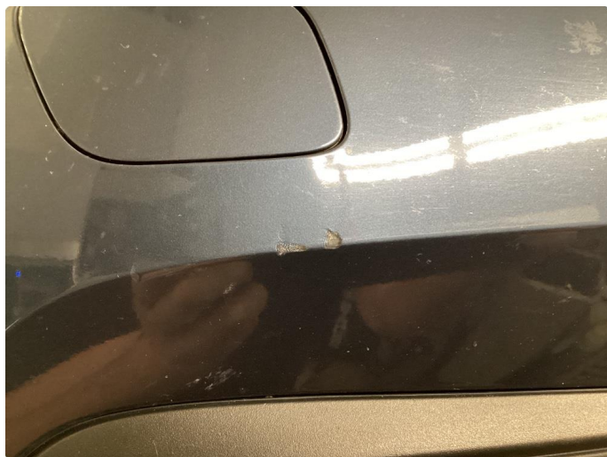
1.2 Ripe(r) ned til grunning
