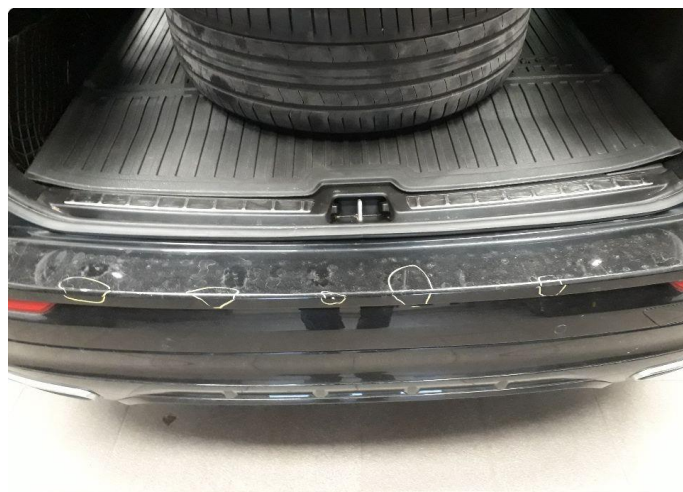
1.2 Ripe(r) ned til grunning
