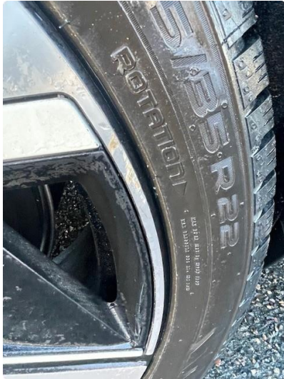
1.1 Små skrubbsår i felg h.bak
