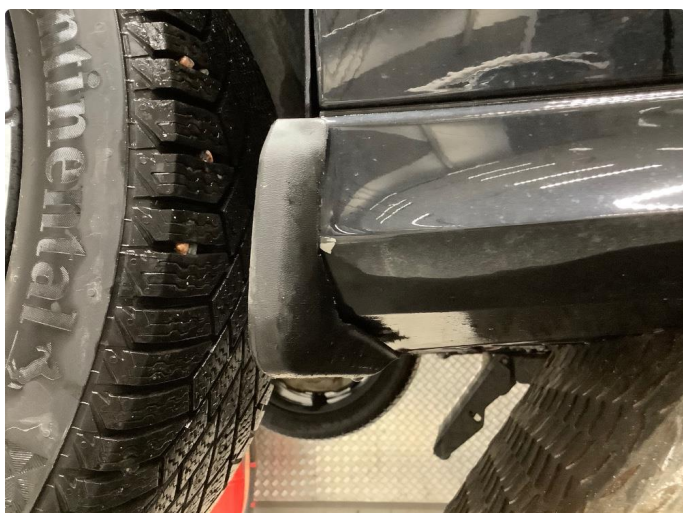
1.2 Noe bruksslitasje i lakk
