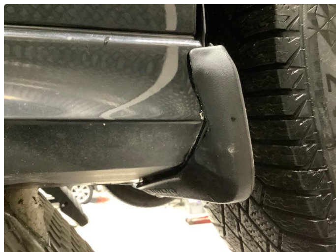
1.2 Noe bruksslitasje i lakk
