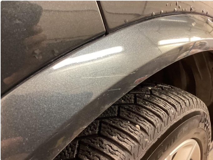
1.1 Noe små riper rundt om som vi polerer før levering
