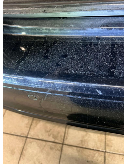
1.2 Ripe(r) ned til grunning
