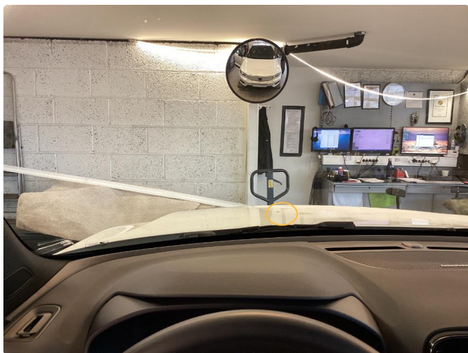
1.3 Steinsprut med sprekk
