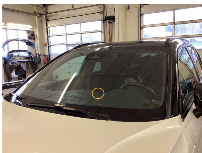
1.3 Steinsprut med sprekk
