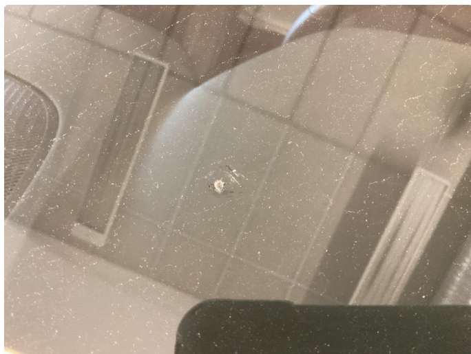
1.3 Steinsprut med sprekk
