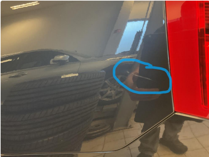
1.1 Ripe(r) ned til grunning
