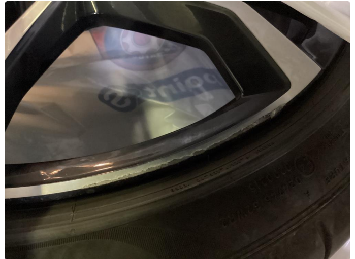
1.1 1 kantkjørt vinterfelg, sommerfelgene er reparert.
