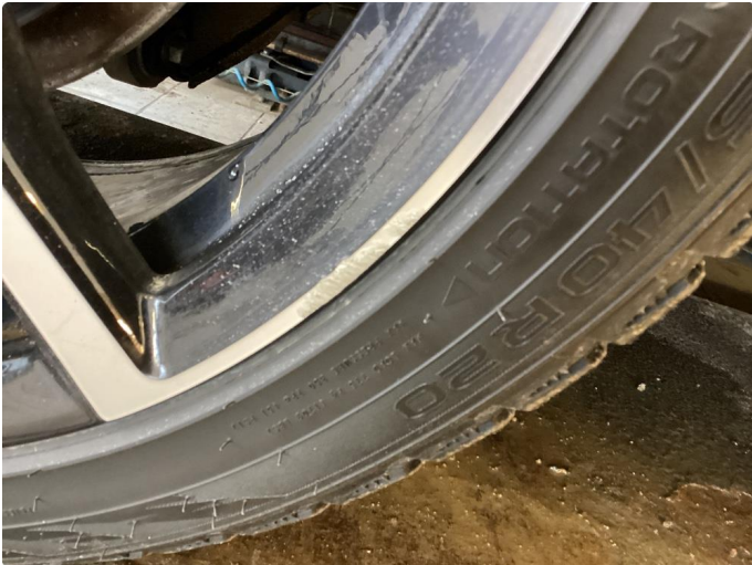
1.1 1 kantkjørt vinterfelg, sommerfelgene er reparert.
