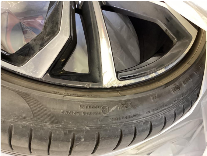
1.1 1 kantkjørt vinterfelg, sommerfelgene er reparert.
