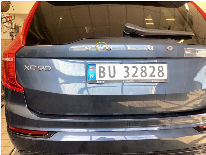
1.1 Bulk - utbedres før levering
