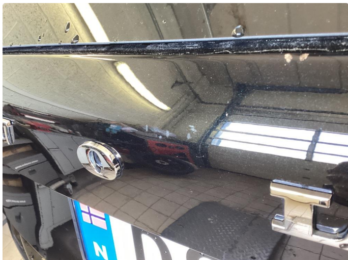
1.1 Overflatiske riper som rubbes og poleres
