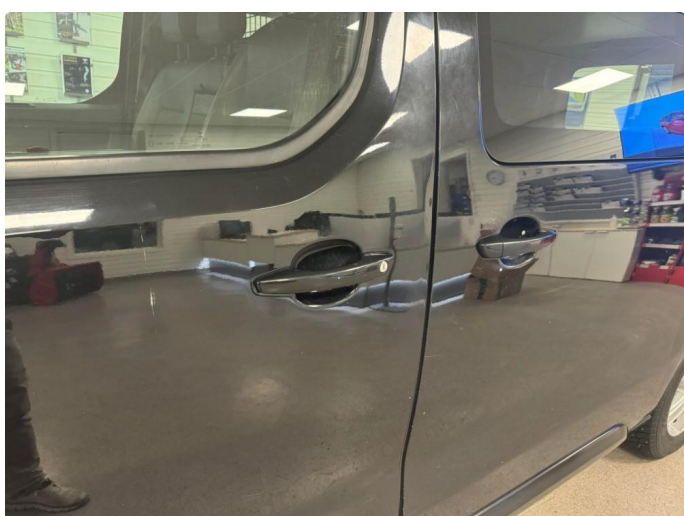
1.3 Lakkskader og malingsflekker på dører og dørhåndtak
