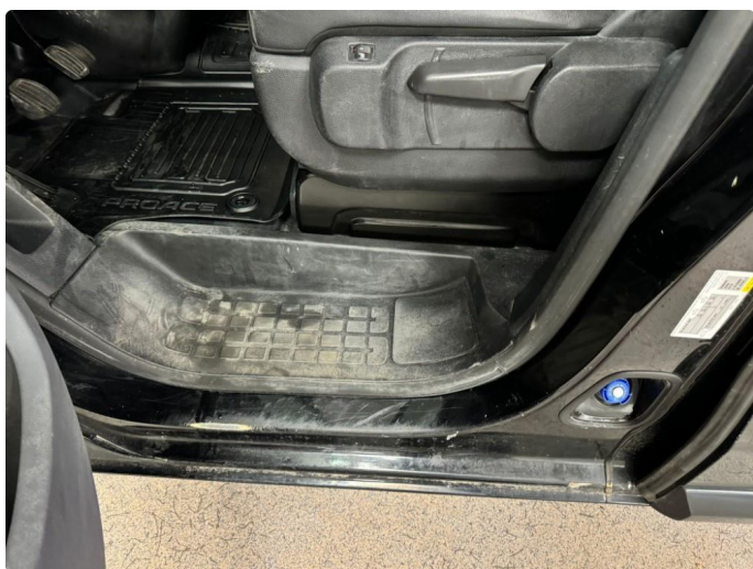
1.5 Slitasje på dørterskler
