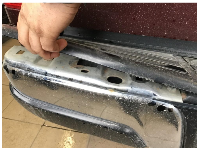
1.5 Plastlist venstre bak på kromfanger løs.
