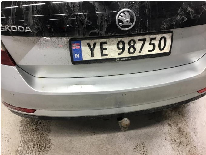
1.3 Skade på støtfanger bak
