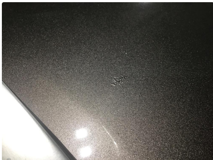
1.4 Steinsprut med rust
