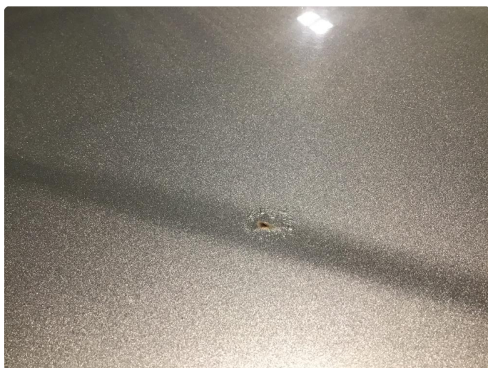
1.4 Steinsprut med rust
