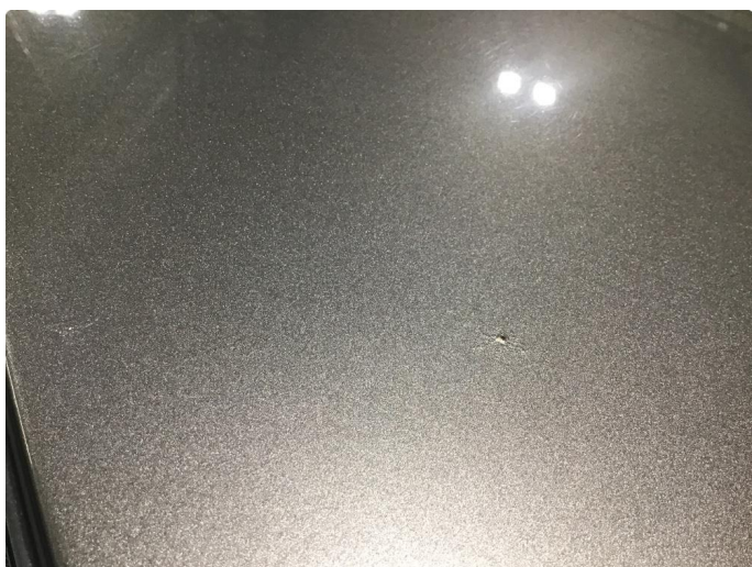
1.4 Steinsprut med rust
