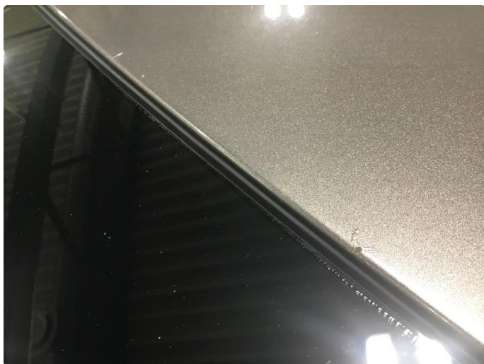
1.4 Steinsprut med rust
