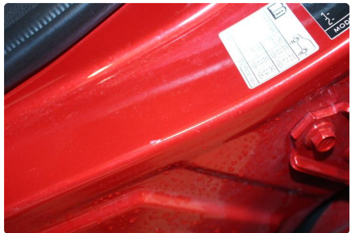
1.2 Noe riper i innsteg
