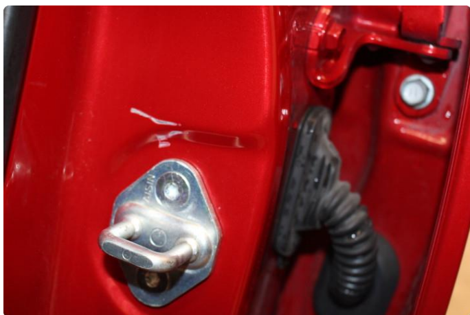
1.2 Noe riper i innsteg
