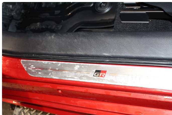
1.2 Noe riper i innsteg
