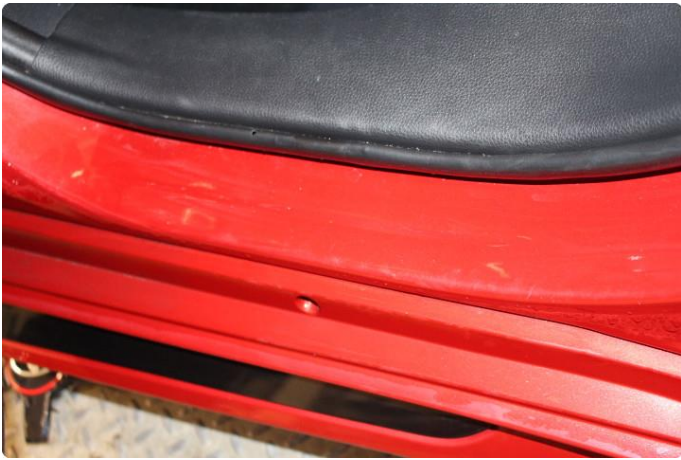
1.2 Noe riper i innsteg
