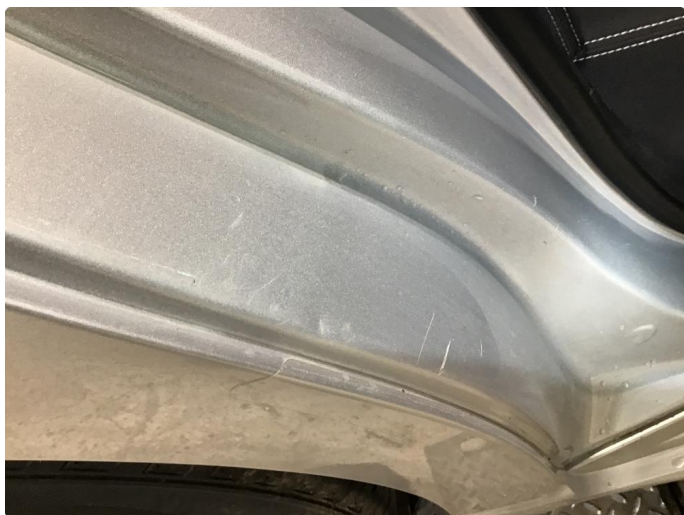
1.4 Slitasje på innsteg
