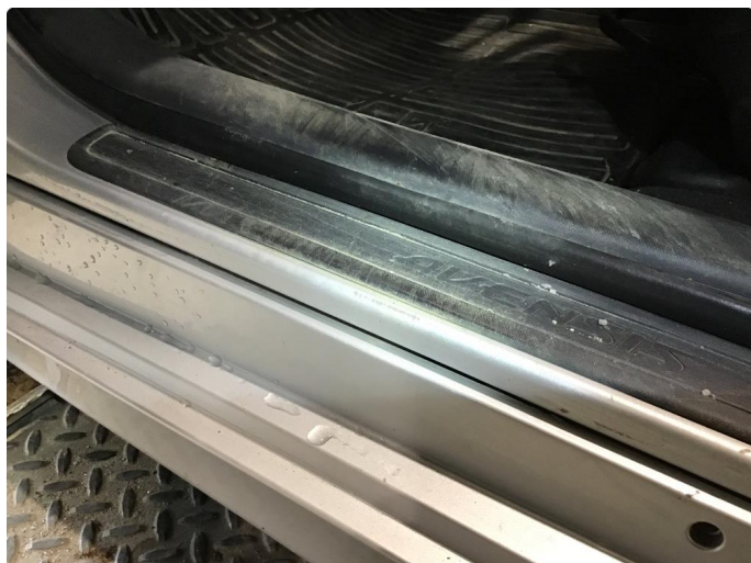
1.4 Slitasje på innsteg
