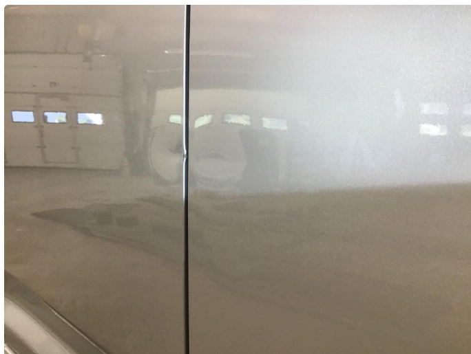
1.2 P-bulk på begge dører høyre side
