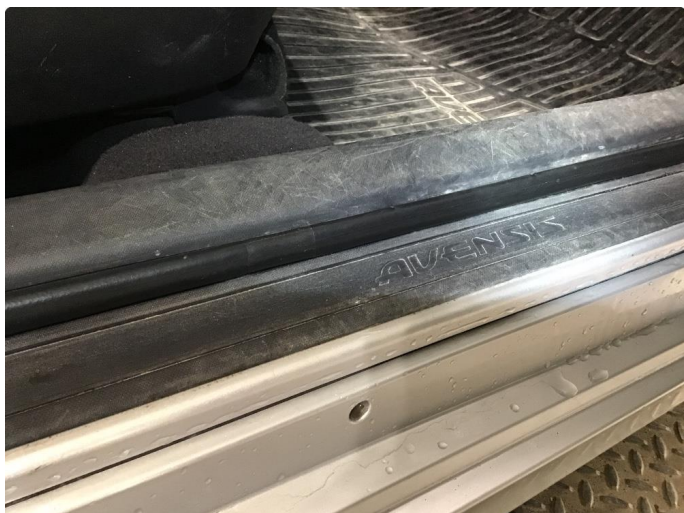
1.4 Slitasje på innsteg
