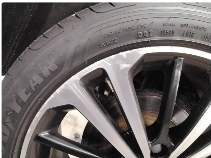
1.1 Noen kantkjørings skader på felgen. Høyre side bak
