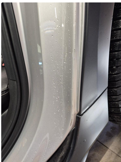
1.1 Ripe(r) ned til grunning
