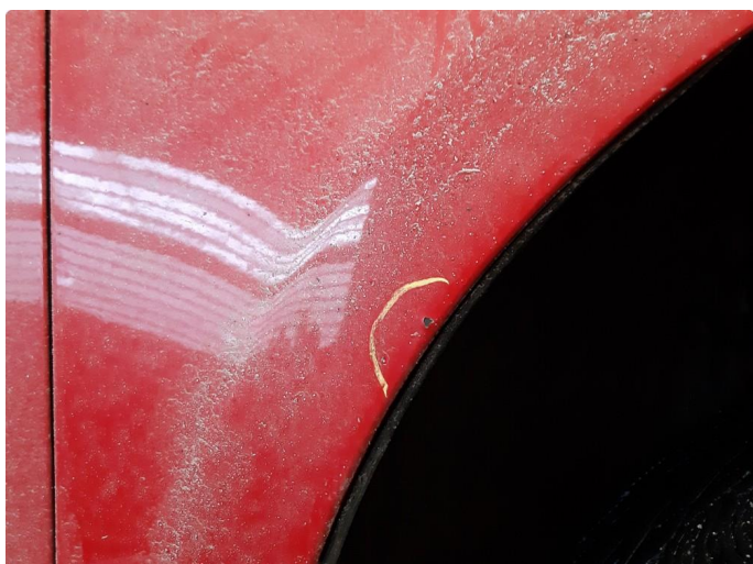
2.2 Steinsprut med rust
