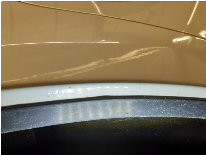
1.2 Steinsprut med rust
