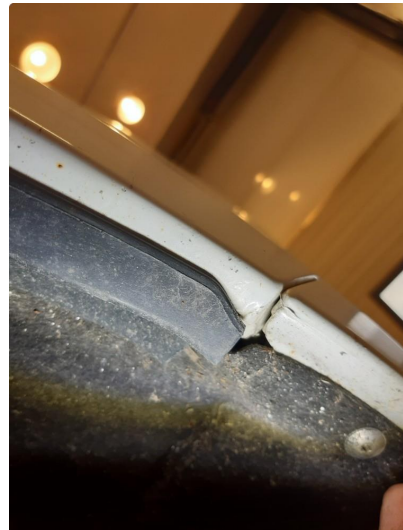
1.2 Steinsprut med rust
