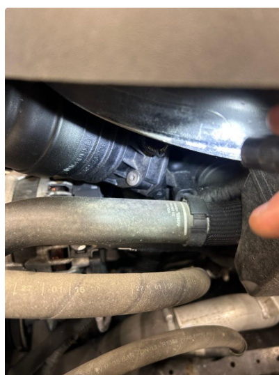
2.1 Oljelekkasje fra motor
