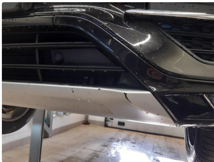
1.6 Ripe(r) ned til grunning
