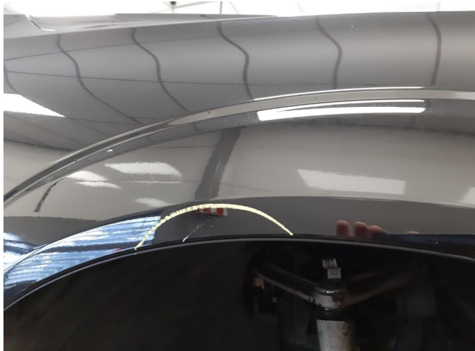
1.1 Ripe(r) ned til grunning
