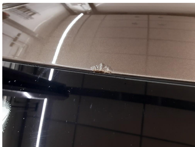
1.4 Steinsprut med rust
