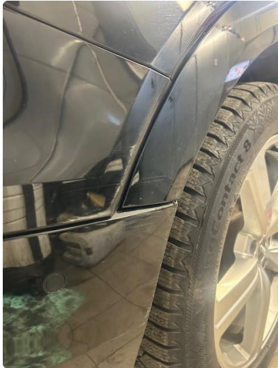
1.2 Ripe(r) ned til grunning
