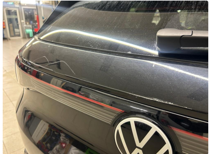
1.3 Ripe(r) ned til grunning
