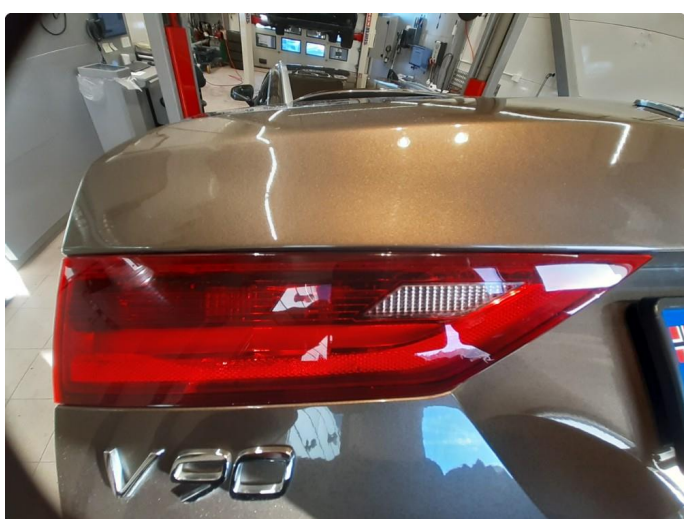
2.1 Defekt / sprukket glass
