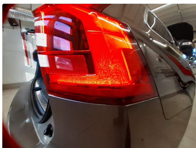
2.1 Defekt / sprukket glass
