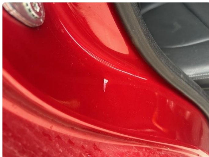
1.2 Ripe(r) ned til grunning
