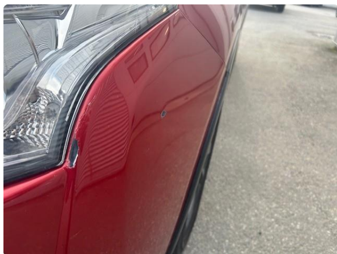
1.3 Ripe(r) ned til grunning
